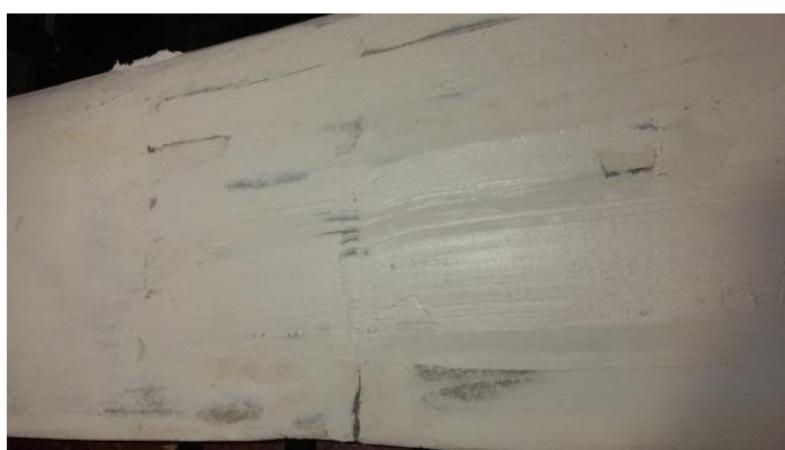
(il faudra encore un ponçage fin avant le gelcoat)
